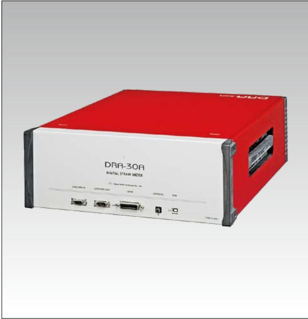
本器はパソコンとのオンライン測定を目的とした多チャンネルデジタルひずみ測定器です。標準付属ソフトウェアDRA-730Aによりデジタル動ひずみ測定器または、多チャンネル同時サンプルデータロガーとして使用可能です。各チャンネル毎に112kワードのデータメモリを内蔵しています。(静ひずみ測定時は、最大30000スキャン)チャンネル毎に1ゲージ法3線式、2ゲージ法、4ゲージ法、電圧測定が設定できます。また全チャンネルにワンタッチコネクタとブリッジボックスを備えていますのでひずみゲージやひずみゲージ式変換器が簡単に接続できます。コンピュータとの通信は、USB1.1インターフェースのほかGP-IBも搭載しています。
