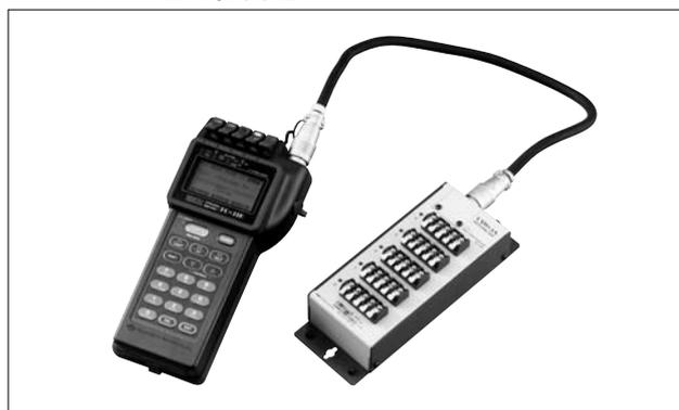
デジタルひずみ測定器TC-31Kと組み合わせて測定点数を拡張するためのスイッチボックスです。測定点数は5点で、ひずみ、直流電圧、熱電対、白金測温抵抗体のいずれも測定できます。
