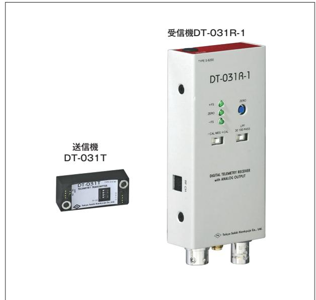
本システムは移動体や回転体など、有線による測定が不可能な対象物のひずみ測定のために開発されたテレメータシステムです。システムは送信機、受信機から成ります。送信機DT-031Tは本体の小型化に加え、無線帯域315MHz（微弱無線設備）を採用することにより、送受信アンテナ設備を含めたシステム全体の小型化が可能です。電源には電池のほか誘導給電（給電システムはオプション）による連続給電も可能です。受信機は小型でかつ操作を簡素化しています。また、TMR-252テレメータ/Fユニットと専用ケーブルCR-6801で接続することで、ひずみ値と送信機電源電圧をデジタル値で記録できます。
