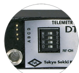
送信機のチャンネル切替え ディップスイッチ
