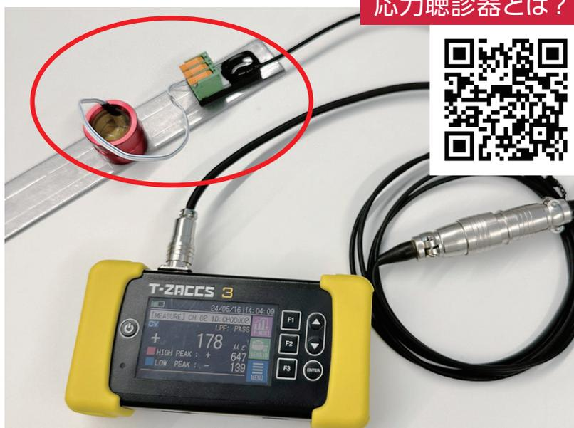
摩擦型ひずみゲージ
