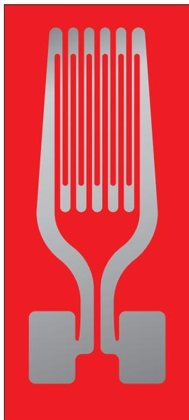
従来のひずみゲージは、ゲージエレメントと称する金属箔に電気信号を伝えるゲージリードが鉛入りはんだで接合されています。鉛入りはんだは鉛とスズの合金であり、柔らかい鉛が応力を緩和させる効果を有しています。一方で、鉛は人体にとって有害物質だけでなく自然環境に対する影響も懸念されます。RoHS指令に伴い、無鉛はんだと従来のひずみゲージ形状の組合せでは、規格であるNAS942に準拠する疲労寿命特性を満足しない場合があります。当社では、無鉛はんだを用いた場合においても応力集中しない新たなはんだタブ形状を採用し、従来のひずみゲージ特性の維持、且つ環境へ配慮した次世代のひずみゲージGOBLETを推奨しています。
