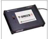
本器は、高速スイッチボックスIHW-50GやスイッチボックスISW-50Gと組合せることで、手軽に多点測定が可能なデータロガーです。ひずみゲージをはじめ、ひずみゲージ式変換器、直流電圧、熱電対、白金測温抵抗体など、ユーザの使用用途に合わせて最大1000点までの測定が行えます。従来のデータロガーに比べて小型・軽量なサイズを実現したことで、様々な計測シーンに対応できます。タッチパネル付きカラー液晶モニタを採用し、明瞭なモニタ表示と快適で直感的な操作性を備え、測定データのモニタや計測後の速やかな確認・検証を可能とします。
