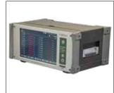
高速・高精度・高機能を兼ね備えた、T-ZACCSシリーズ最上位のデータロガーです。ひずみゲージをはじめ、ひずみゲージ式変換器、熱電対、白金測温抵抗体、直流電圧などの測定が可能です。測定点数は本体10点、外部測定ボックスを併用することで最大1000点までの測定が可能で、あらゆる規模の測定に対応できます。独自の高精度・高安定と高速測定を両立する次世代A/D方式とEthernetをベースとした超高速フィールドネットワークの採用により、各種熱起電力、増幅器の零点移動、商用電源ノイズを除去し、高精度で高安定な測定を実現しながら、測定点数に関係なく、高速モードは0.1秒、高精度モードは0.4秒(50Hz)間隔の測定とストレスフリーな操作性を実現し、静的現象から準動的現象まで、幅広い現象の測定に対応できます。パソコンを用いることなく、さまざまなモニタ、さまざまな自動測定、さまざまな演算が可能です。外付けのアナログ出力ユニットにより、測定に連動した電圧出力も可能です。T-ZACCS9 TS-960は、全てが詰まった、オールインワンデータロガーです。
