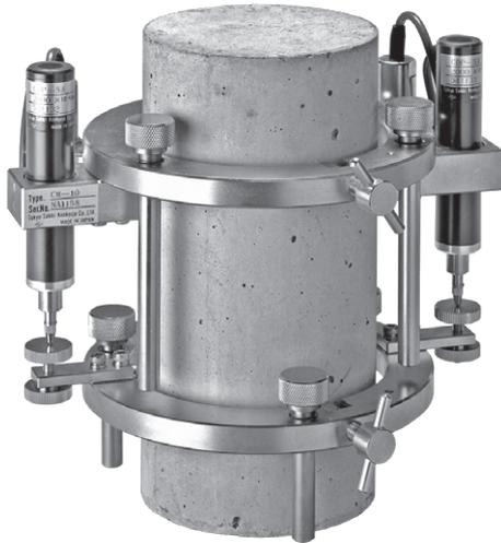
コンクリート円柱供試体の強度試験での軸方向のひずみ測定に使用するコンプレッソメータです。円柱供試体を取付枠の中に挿入し、ねじを締め付けてセットします。ひずみ量の検出には高感度変位計を用いており、測定値に一定の係数をかけることによりひずみ値が求められます。通常のひずみゲージと異なり繰り返しの使用が可能で、取扱いも簡単で、水中養生直後などのまだ乾燥していない状態でのひずみ測定が可能です。なお、本器は、供試体の破壊までの測定はできません。
